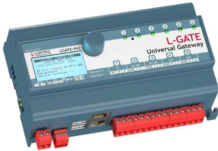
L-GATE 閘道器其作為通用閘道器的設計，使其可匹配並連接不同通信技術的資料點。此一匹配及連接具體而言即是所謂的“連線”。配置工具藉由使用智能自動連線™功能，即可以手動或自動方式建立這樣的連線。區域及全域連線有所區別本地連接允許同一裝置上不同通信技術的資料點之間，可以進行“連線”。“全域連線”提供類似區域連線的功能，但可跨越兩個或更多 LOYTEC 裝置之間的 IP 網路進行通訊。全域連線可建立一個資料雲，並以適用全系統的名稱來予以命名。屬於資料雲成員的資料點，即可自動更新其輸入值，也可傳送輸出值予其他雲成員，更新它們的資料點數值。
