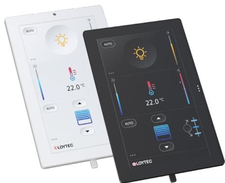
搭配BACnet、EnOcean、LonMark、Modbus、Bluetooth、OPC XML/DA與OPC UA功能的LPAD-7觸控面板，適合使用於樓宇自動化的圖形操作。LPAD-7可以作為區域控制面板、網路溫控器，內建電容式觸控適合使用在辦公室、會議室、旅館區域、郵輪客房或家裡。L-PAD/L-VIS/L-WEB 設定軟體，允許使用者自行製作操作頁面。LPAD-7 使用四核心低耗電中央處理器。LPAD-7 遵循最高安全並能夠在未來數年定期更新軟體。
