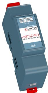
LRS232-802 介面可通過兩個 RS-232序列埠擴充LOYTEC 設備。可連接到設備的USB 埠，並且配置為運轉 Modbus ASCII、RTU或由腳本 ( script ) 模組實施自定義序列協議 ( 腳本需L-IOT1授權 )。LRS232-802 可與兼容的 L-INX自動化伺服器、L-ROC 區域控制器、L-IOB I/O 控制器、L-DALI 控制器、L-GATE通用閘道器以及大多數 L-VIS 觸摸面板一起使用。因USB匯流排介面，設備不需要電源，它就會被自動偵測到。
