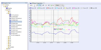
LOYTEC裝置可以紀錄各資料點的數值。然而裝置上的記憶體容量是有限的，因此LWEB-900利用定期讀取趨勢資料，並儲存於資料庫來克服這個限制。最快的趨勢紀錄設定方式，使用者可以在LWEB-900上，直接建立趨勢紀錄。只要選取紀錄點並使用功能表單，啟動趨勢紀錄，LWEB-900會定期輪詢裝置上資料點數值，並儲存於資料庫。若LWEB-900伺服器無法透過IP直接存取LOYTEC裝置，可透過各裝置自動將趨勢資料以附檔方式，利用電子郵件傳送給伺服器。趨勢紀錄可以使用表格或圖表方式呈現。而圖表的呈現方式，可以設定多種不同的顯示選項。此外，LWEB-900可以將趨勢紀錄以CSV檔案格式匯出。
