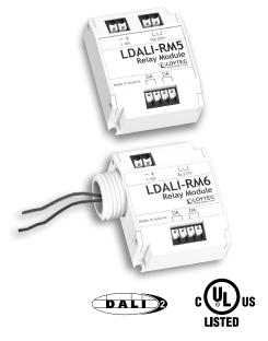
LDALI-RM 繼電器模組可控制不具備 DALI 功能的設備。通常用於整合非DALI 燈具 ( 也可控制 1 – 10 V 調光介面) 或其他整合於 DALI 燈光控制的電氣設備, 如廁所或盥洗室風扇、隔間牆動作馬達、投影布幕等等。
