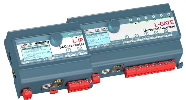
各型 L-IP 路由器，即 LIP-1ECTC、LIP-3ECTC、LIP-33ECTC 以及 LIP-3333ECTC，可連接雙絞線通道 (TP/FT-10 或 TP/XF-1250) 至 LonMark 系統中的乙太網路/IP 通道 (IP-852)。L-IP 可發送 CEA-709 封包，經由 IP 網路，例如：LAN (乙太網路)、內網或甚至國際網路。
