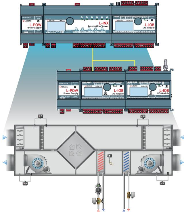
L-INX 自動化伺服器是可編程、適合多種通訊協定的裝置，並可以透過隨插即用的方式擴充 L-IOB I/O 模組。L-INX 自動化伺服器搭載易懂的警報、排程、趨勢紀錄 (AST)、email 通知功能，並能夠存放圖形化頁面提供標準的網頁瀏覽器存取。
