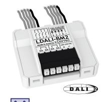
LDALI-BM2 按鍵耦合器,可整合最多四個客製化燈控按鍵及開關至一個 DALI 通道。或者,四路輸入中的兩路可作為類比輸入,連接諸如滑鈕、旋鈕 等裝置,或是基於電阻的感測器,諸如 NTC 溫度感測器。
