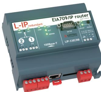
L-IP 備援路由器可連接雙絞線通道 (TP/FT-10 或 TP/XF-1250) 至 LonMark 系統的乙太網路/IP-852 通道，並允許建立一個具備援能力的網路基礎設施。整合的演算法可偵測並“癒合”TP/FT-10 通道上的斷線，並有助於立即找到故障點。此外，L-IP 備援路由器可監測 TP/FT-10 通道上的節點，並在發生故障的情況下發出警報。為此，L-IP 備援路由器只何作為配置完成之路由器來使用。
