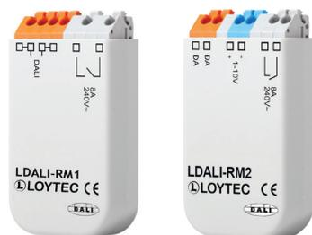
LDALI-RM繼電器可使用DALI通道，控制標準的電力消耗(Standard Consumers)。內建繼電器接點可以使用最高8A電流於最大2000 VA的電壓。並設計成可以承受80A的突波電流。
