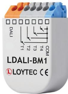
LDALI-BM1按壓按鈕耦合器整合常用的燈光按壓開關於DALI通道。精簡的4路可程式化開關輸入模組，可以與LOYTEC DALI控制器搭配使用。當按壓按鈕被按下時，DALI命令將傳送到DALI通道中的一個群組或跨越DALI匯流排的限制傳送到對應的大樓網路(需透過L-DALI控制器)
