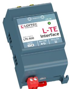
LTEインターフェースは、移動体通信事業者のLTEネットワークにおけるワイヤレスモバイル接続を用いてLOYTECデバイスの能力を拡張します。LTEインターフェースは、ほとんどのLOYTECデバイスのUSBポートに接続できます。LTEインターフェースへの電力は24VDCの電力コネクタを通じて供給されます。
