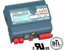
LGATE-902ゲートウェイはユーザ固有のグラフィックページを表示できるパ ワフルなゲートウェイです。このゲートウェイは、CEA-709 (LonMarkシステム) 、BACnet、KNX、ModbusおよびM-Busを同時に組み込む接続機能を提供します。ロー カルのオペレーションとオーバーライドはビルトインジョグダイヤルとバックライト式デ ィスプレイ(128×64ピクセル)で行われます。デバイスとデータポイントの情報はWeb インターフェースで提供され、記号とテキスト形式でディスプレイに表示されます。.
