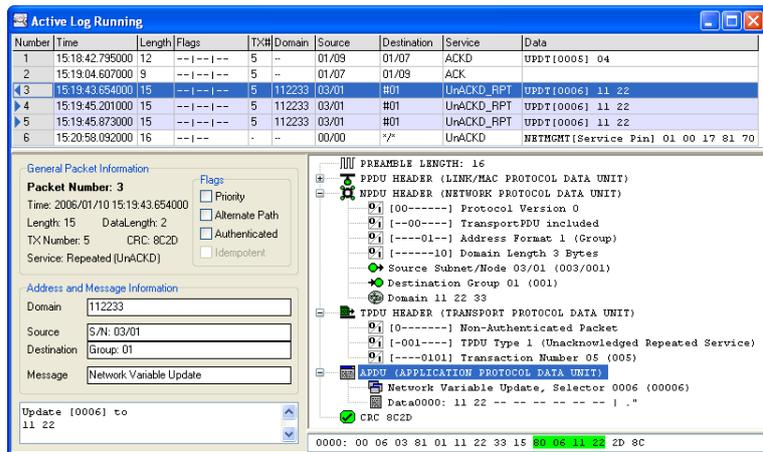
1回のマウスクリックで、ビルトインレポート機能は調査したチャンネルの品質状態を示すレポート (テキストファイル) を作成し、このチャンネルの問題を解決する方法に関するヒントや助言を示します。
