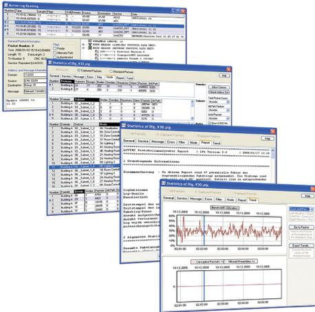
LonMarkシステム用のLOYTECプロトコルアナライザ (LPA) はCEA-709またはIP-852ネットワーク上のすべてのデータパケットを取り込み、記録されたすべてのパケットをPCスクリーン上に表示します。LPAソフトウェアはデータパケットを表示し、フィルターにかけてビットレベルに至るまで解析する機能と方式の包括的なセットを提供します。
