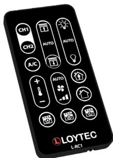
La L-RC1 est une télécommande infrarouge conçue pour les applications d'automatisation de locaux. Elle permet le contrôle des lumières de la pièce, des stores et de la CVC.
