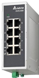
Le LOYDVS-008100 est un Switch Fast Ethernet 8 ports non administré avec une conception matérielle améliorée, une protection des paquets et une compatibilité avec de multiples standards de communication industrielle. Le LOYDVS-008100 offre une large plage de températures de fonctionnement allant de -10 °C à 60 °C et est certifié UL, CE et FCC.
