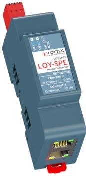
Le LOY-SPE2 est un convertisseur double Ethernet à paire unique (SPE). Il comprend deux convertisseurs Ethernet (10BASE-T) indépendants vers Ethernet à paire unique (10BASE-T1L, norme IEEE 802.3cg).
