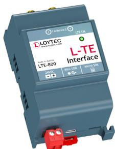
L'interface LTE permet à un équipement LOYTEC une connexion mobile sans fil dans le réseau LTE d'un fournisseur de téléphonie mobile. L'interface LTE peut être connectée au port USB de la plupart des appareils LOYTEC. L'alimentation de l'interface LTE est fournie via le connecteur d'alimentation 24 VDC.
