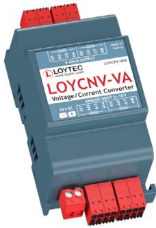
Das LOYCNV-VA8 ist ein Spannungs-Stromwandler mit acht 4-20 mA Stromausgängen, die von acht 0-10 V Ausgängen eines L-IOB, LROC-400 oder LROC-402 gesteuert werden.
