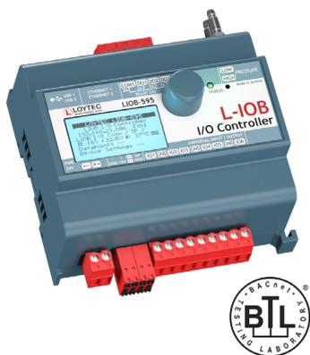
LIOB 595 I/O Controller sind IP-fähige, kompakte, programmierbare BACnet Building Controller (B-BC) mit physikalischen Ein- und Ausgängen und integrierter, grafischer Visualisierung.
