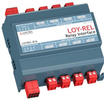
Das LOYREL-816 ist eine Relais-Schnittstelle mit acht 16 A Relais, die von acht 0/10V Ausgängen eines L-IOB, LROC-400 oder LROC-402 gesteuert werden.
