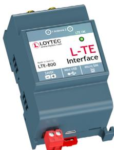
Die LTE-Schnittstelle erweitert ein LOYTEC-Gerät um eine drahtlose Mobilfunkverbindung im LTE-Netzwerk eines Mobilfunkanbieters. Das LTE-Interface kann an den USB-Port der meisten LOYTEC-Geräte angeschlossen werden. Die Stromversorgung der LTE-Schnittstelle erfolgt über den 24 V Spannungsanschluss.
