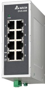
Der DVS-008I00 ist ein nicht gemanagter 8-Port Fast Ethernet Switch mit verbessertem Hardware Design und Kompatibilität mit verschiedensten industriellen Kommunikationsstandards. Der Betriebstemperaturbereich reicht von -10°C bis 60°C. Der DVS-008I00 ist UL, CE und FCC zertifiziert.
