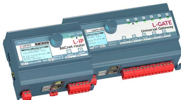
Ebenso bieten sie „Foreign Device“-Unterstützung. Die L-IP Router LIP-1ECTC, LIP-13-ECTC, LIP-3ECTC, LIP-33ECTC und LIP-3333ECTC verbinden im LonMark-System 2-Draht-Kanäle (TP/FT-10 oder TP/XF-1250) mit dem Ethernet/IP-Kanal (IP-852). Dazu vermitteln sie CEA-709 Datenpakete über einen LonMark IP-852 Kanal, wobei LAN, Intranet und Internet unterstützt wird.
