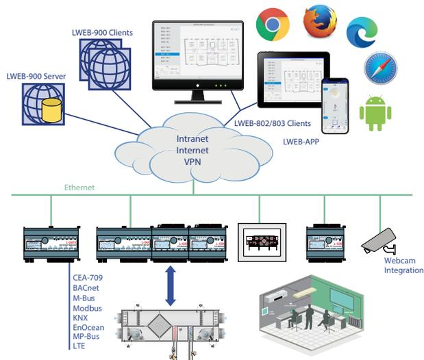
Jede Aktion im System wird pro Nutzer mitprotokolliert. Die auf die L-INX, L-ROC, L-VIS, L-DALI, L-IOB I/O Controller, LIOB-AIR und L-GATE Geräte verteilten Alarming-, Scheduling- und Trending- (AST™) Funktionen werden automatisch mit dem LWEB-900 Server synchronisiert. So stehen die AST™-Funktionen genau dort zur Verfügung, wo sie für die Gebäudeautomation gebraucht werden und sind voll in das L-WEB System integriert.
