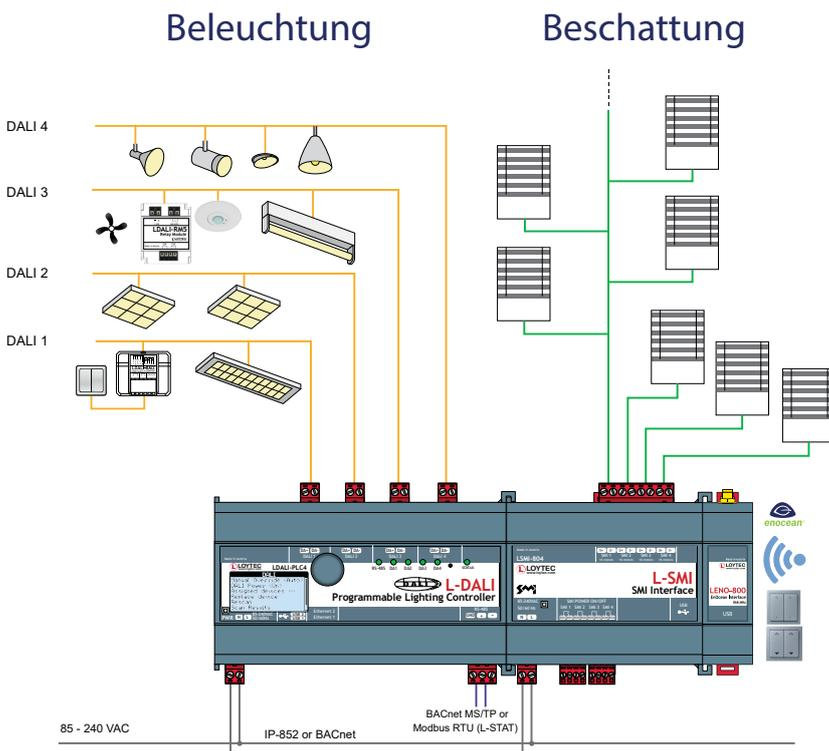
L-DALI Controller bieten vielfältige Funktionen für eine umfassende DALI (Digital Addressable Lighting Interface) Beleuchtungssteuerung. Gleichzeitig integrieren sie das angeschlossene DALI-System in LonMark-Systeme oder BACnet-Netzwerke. Neben der Integration von DALI-Vorschaltgeräten und DALI-2-zertifizierten Eingabegeräten unterstützen die L-DALI Controller eine Vielzahl von L-DALI Geräten (Relais- und DALI zu 1-10V Konvertermodule, Phasendimmer, PWM-Module, Tasterkoppler und Multisensoren).
