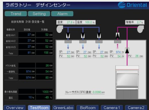
Laborabzüge, Ab- und Zuluft-VAV, Raum-Druck-Sensoren, Temperatur und Feuchtigkeitssensoren sind hier eingebaut. LINX-110, LIOB-450 und LIOB-452 steuern Luftausgleich und Luftdruck und errechnen die Gleichzeitigkeitsrate.
