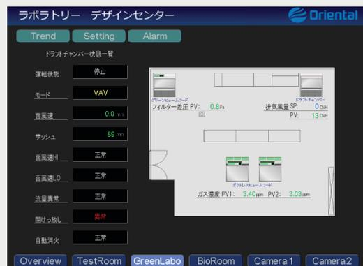
Es gibt mehrere Arten von Laborabzügen zum Absaugen von toxischen Gasen durch spezielle Filter. LIOB I/O Controller zeigen die Konzentration und den differentiellen Druck über Trend-Grafiken von LWEB-802 an.
