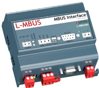
L-MBUS 电平转换器，可用来连接 M-bus 网络至 LOYTEC 装置。最多达 20 或 80 个 M-bus 装置能够通过 L-MBUS20 或 L-MBUS80 来予连接。
