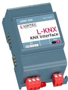
KNX-界面 LKNX-300 可允许 L-INX 自动化服务器、L-ROC 房间控制器，以及 L-GATE 通用网关，均得以连接到已连接于 KNX TP1 总线的 KNX 装置之上。LKNX-300 界面需要连接到 L-INX/L-ROC/L-GATE 装置的 EXT-Port 上。
