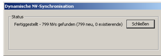
Abbildung 112: Synchronisation dynamischer NVs vom Gerät
