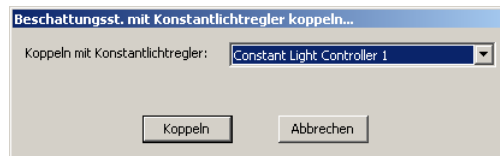
Abbildung 204: Dialog zum Koppeln von Beschattungssteuerung und Konstantlichtregler.
