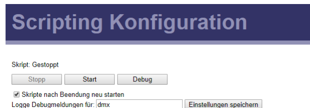
Abbildung 236: Einstellen eines Debug-Schlüsselworts um Modulmeldungen zu aktivieren
