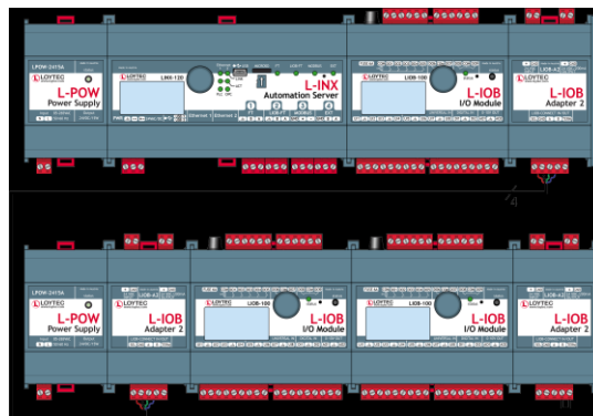
Abbildung 26: Verwendung des LIOB-A2 Adapters zur LIOB-Connect Erweiterung
