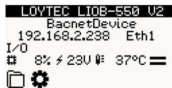
Abbildung 32: Hauptseite des LIOB-55x/56x LCDs im BACnet Gerätemodus
