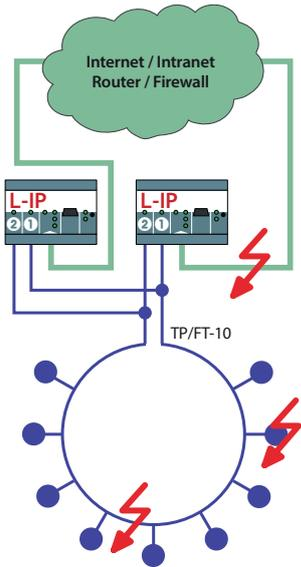
Der L-IP Redundant verbindet einen TP/FT-10 Kanal mit einem IP-852 (Ethernet/IP) Kanal in LonMark-Systemen und ermöglicht den Aufbau von redundanten Netzwerken. Der integrierte Algorithmus erkennt eine Leitungsunterbrechung am TP/FT-10 Kanal und hilft, den Fehler unverzüglich zu finden. Zusätzlich werden am TP/FT-10 Kanal angeschlossene Knoten überwacht und Knotenausfälle angezeigt. Der L-IP Redundant kann nur als konfigurierbarer Router eingesetzt werden.
