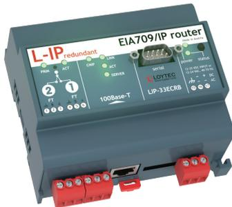
Der L-IP Redundant verbindet einen TP/FT-10 Kanal mit einem IP-852 (Ethernet/IP) Kanal in LonMark-Systemen und ermöglicht den Aufbau von redundanten Netzwerken. Der integrierte Algorithmus erkennt eine Leitungsunterbrechung am TP/FT-10 Kanal und hilft, den Fehler unverzüglich zu finden. Zusätzlich werden am TP/FT-10 Kanal angeschlossene Knoten überwacht und Knotenausfälle angezeigt. Der L-IP Redundant kann nur als konfigurierbarer Router eingesetzt werden.
