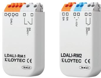
Die LDALI-RM Relaismodule ermöglichen das Ansteuern von handelsüblichen Verbrauchern über einen DALI-Kanal. Der eingebaute Relaiskontakt kann für Ströme bis zu 8 A bzw. mit Lasten bis zu 2 000 VA eingesetzt werden. Das Modul ist für einen maximalen Einschaltstrom von 80 A ausgelegt.
