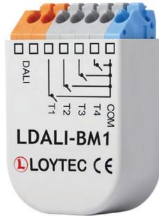
Der LDALI-BM1 Taster-Koppler bindet bis zu vier handelsübliche Lichttaster und Schalter in einen DALI-Kanal ein. Mit den LOYTEC DALI-Controllern steht damit ein kompaktes Steuermodul mit 4 frei programmierbaren Schalteingängen zur Verfügung. Bei Tastendruck werden DALI-Befehle an eine DALI-Gruppe innerhalb des DALI-Kanals gesendet, oder auch über die DALI-Busgrenzen hinweg in das jeweilige Gebäudenetzwerk (via L-DALI Controller) abgesetzt.
